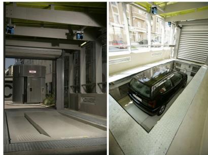
Auf einer Palette abgestellt, werden die Fahrzeuge nach Verlassen des Raumes automatisch mit einem Lift in die Garage verfahren.
